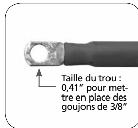
Fig. 3,13. Terminaison câble positif
